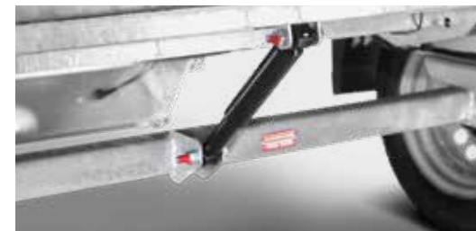
Kippbarer Kastenaufbau (beim HA kippbar) mit Stoßdämpferunterstützung
