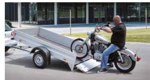
Auffahrsituation beim kippbaren HA
