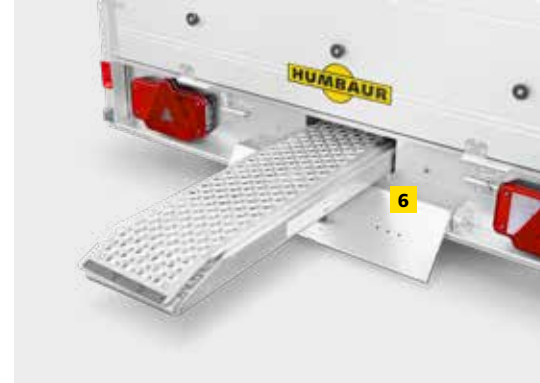
Optionale Alu-Auffahrschienen im Unterfahrschutz einschiebbar
