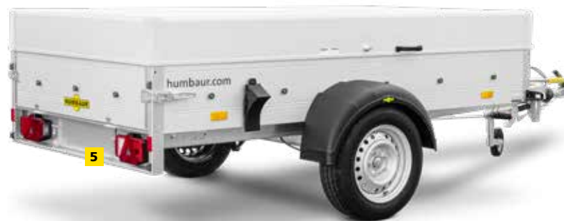
Optionale Alu-Auffahrschienen im Unterfahrschutz einschiebbar
