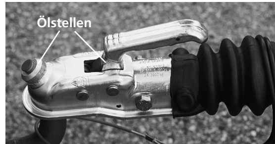
Ölstellen der Kugelkopfkupplung
